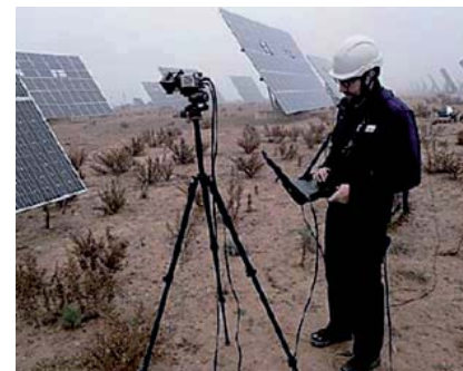
Técnico de CENER realizando medidas de EL en campo
