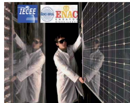
Ensayo de LID en interior
