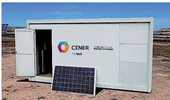
Laboratorio móvil para medida de EL de los módulos a su llegada a campo.
