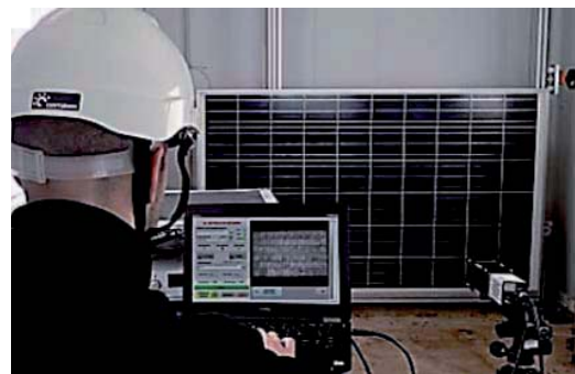
Técnico de CENER realizando medida de EL en el interior del laboratorio móvil.
